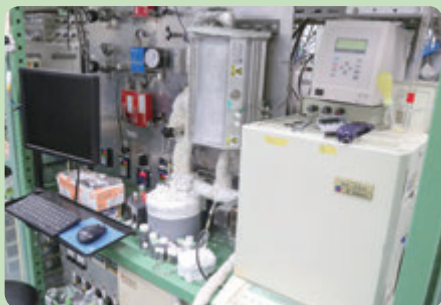
触媒反応装置 目的に合わせて機器を組み合わせオリジナルの装置を作っています。
